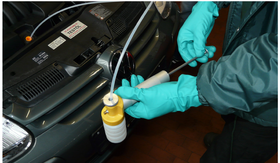
Entnahme einer Ölprobe für die Prüfung
